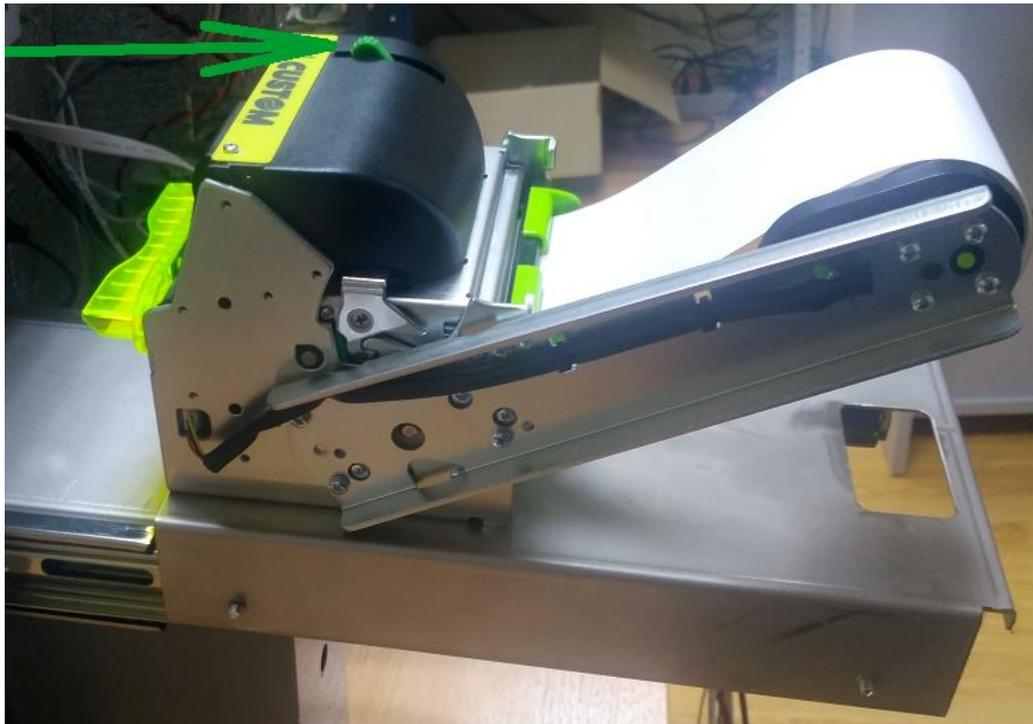
Рисунок 7. Рычаг для открытия верхней крышки принтера
