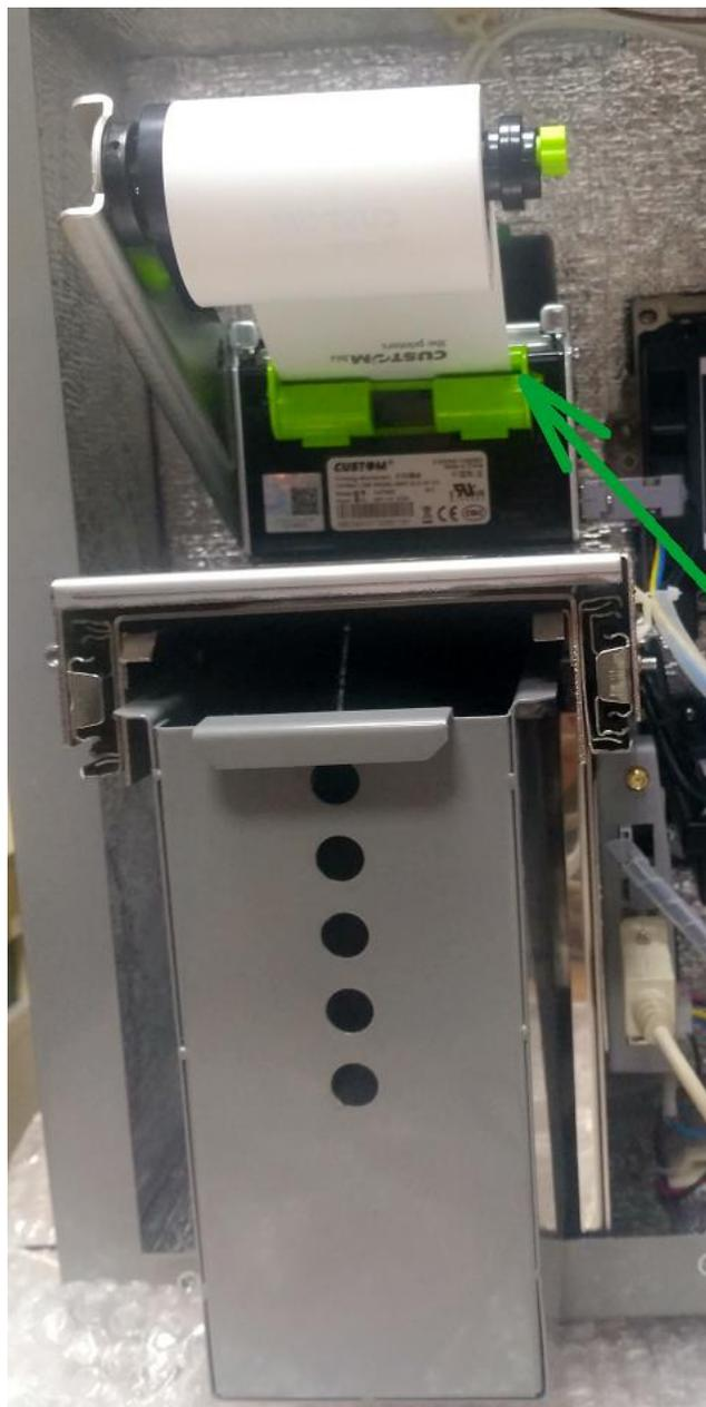
Рисунок 9. Подача бумаги во входную щель принтера
