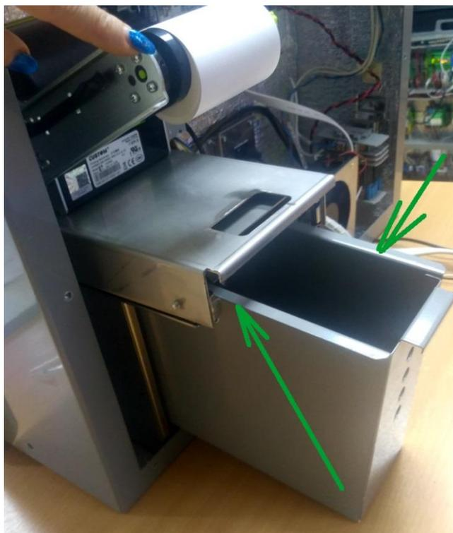
Рисунок 5. Выдвижение ретрактора
