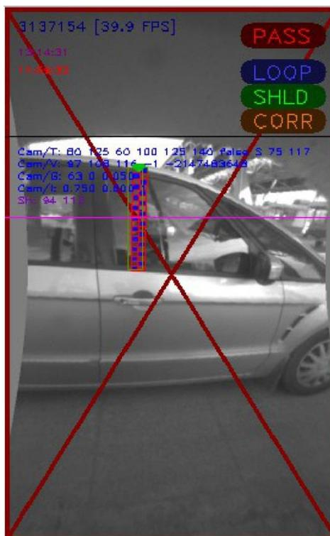
Рисунок 27. Окно утилиты avc\_core\_monitor в момент проезда ТС
