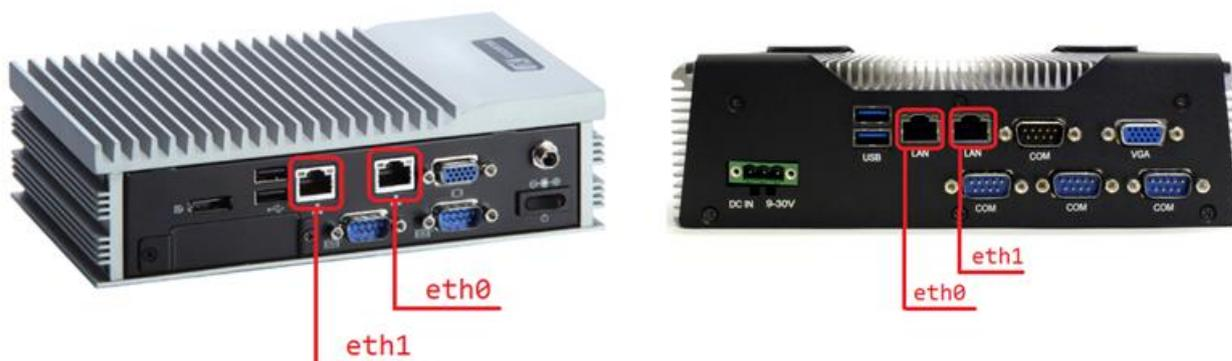
Рисунок 20. Расположение Ethernet-портов на вычислителе типа eVOX620-110-FL-T56N (слева) и вычислителе типа AAЕON АЕС-6637 (справа)
