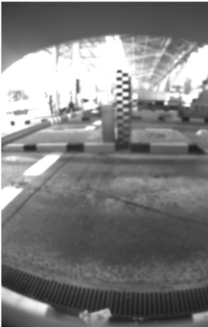
Рисунок 14. Видеоизображение при неправильно настроенном фокусе
